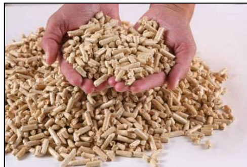
FIGURE 3 : EXEMPLE DE PELLETS OBTENUS PAR COMPRESSION DE SCIURES
